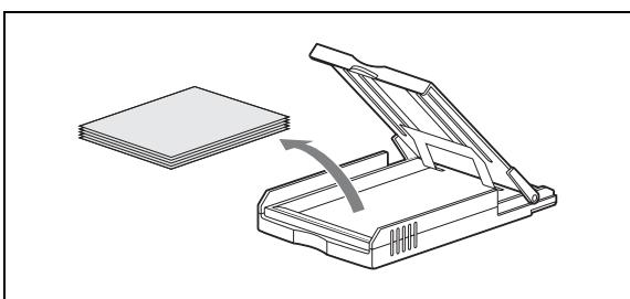
**2** Placez la feuille protectrice dans le bac avec la face non imprimée vers le haut et vérifiez que les flèches sur le bas du bac et celles sur le dos de la feuille sont dirigées vers la même direction, puis insérez le bac à papier dans l'imprimante.
